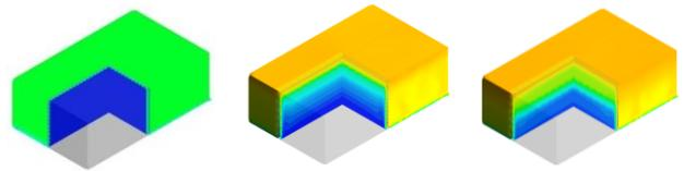
Figure 10. Temperature inside the brick at t=0 min, t=2,5 min, t=5 min
