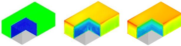
Figure 12. Temperature inside the brick at t=0 min, t=2,5 min, t=5 min
