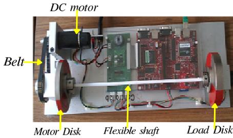
Fig. 1. Experimental torsion bar
