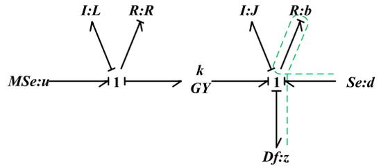
Fig. 2. BGD model of the DC moteur
