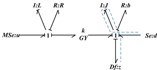
Fig. 1. BGI model of the DC moteur
